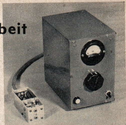
Abb. 5. Ansicht des fertigen Prüfgerätes. Links der Tastkopf mit der Rauschdiode
