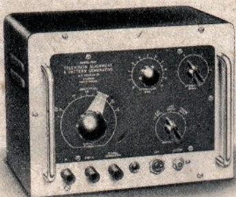
Fernsehgleich- und Bildmuster-generator Typ 1320 „Tele-Check“ von Cossor
